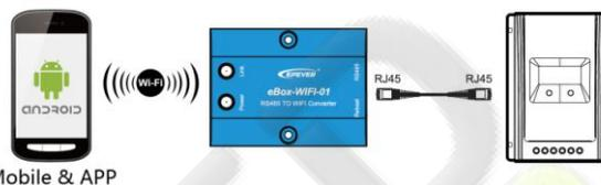
REMARQUE: Un câble réseau standard (câble parallèle) peut réaliser la connexion!
