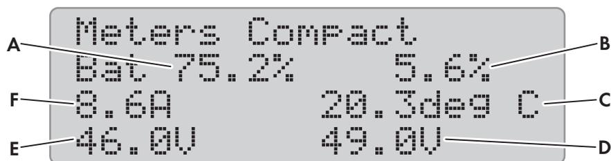
Figure 15 : Vue d'ensemble du menu **Meters Compact** pour la batterie
