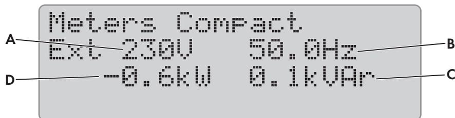
Figure 17 : Vue d'ensemble du menu **Meters Compact** pour le générateur ou le réseau d'alimentation de secours
