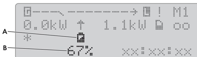
Figure 9 : État de charge de la batterie en mode Standard (exemple)
