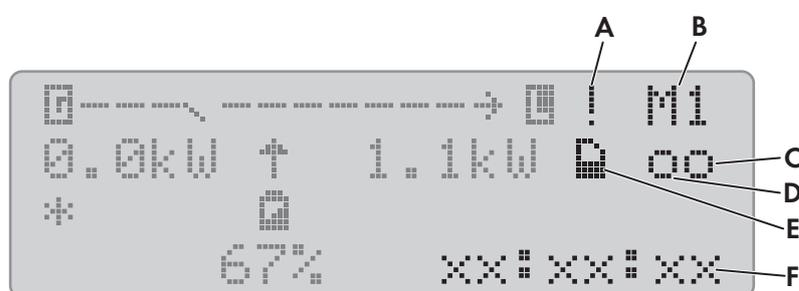
Figure 8 : État de l'onduleur Sunny Island (exemple)
