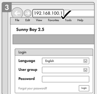
**K** Wechselrichter über Ethernet konfigurieren | Configuring the inverter via Ethernet | Διαμόρφωση μετατροπέα μέσω Ethernet | Configuración del inversor mediante ethernet | Configuration de l'onduleur via Ethernet | Configurazione dell'inverter mediante Ethernet | Konfigurace střídačů prostřednictvím Ethernetu | Omvormers via ethernet configureren | Konfiguracja falownika poprzez Ethernet | Configurar inversores via Ethernet
