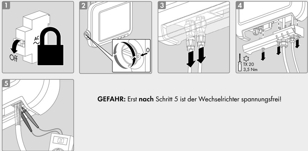
**GEFAHR:** Erst **nach** Schritt 5 ist der Wechselrichter spannungsfrei!
