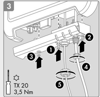
**F** PV-Generator anschließen | Connecting the PV Array | Σύνδεση της Φ/Β γεννήτριας | Conexión del generador fotovoltaico | Raccordement du générateur photovoltaïque | Collegamento del generatore fotovoltaico | Připojení FV generátoru | PV-generator aansluiten | Podłączenie generatora fotowoltaicznego | Ligar o gerador fotovoltaico
