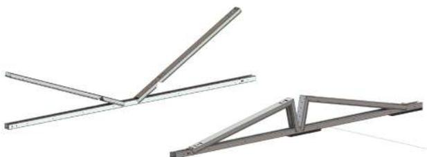
Fixez la partie mobile du triangle de montage au rail au moyen de 2 vis à tôle (Ø6.5x 19mm).
