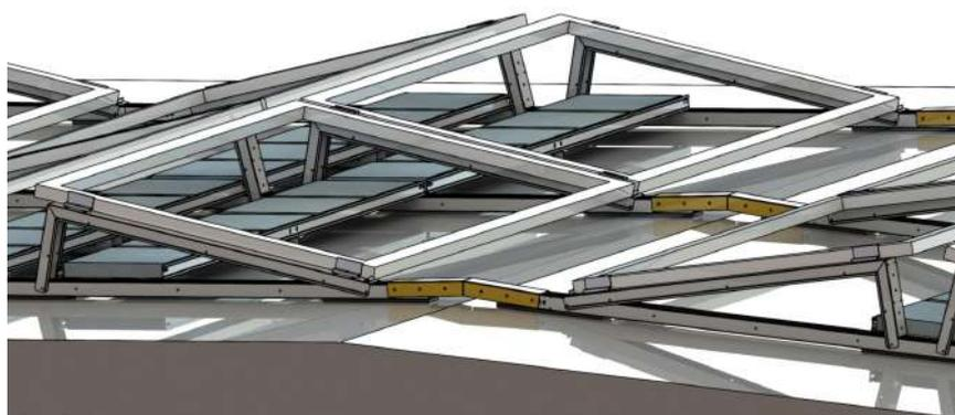
Pour le raccord de faîtage transversal, le profilé de faîtage sera placé aux extrémités des profilés. Au milieu, le profilé de faîtage peut être plié en fonction du degré de la pente. Il est ensuite fixé avec 8 vis auto-taraudeuses ( $\varnothing 5.5 \times 25 \text{mm}$ ) aux unités de base.
