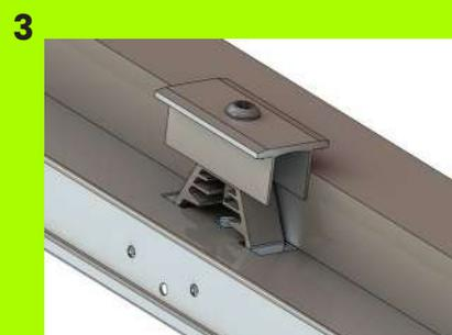
Serrez l'étrier avec un couple de 10-15 Nm.
