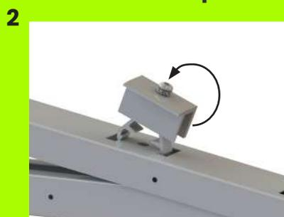
Clipsez maintenant l'autre côté du support de serrage sous la plaque de serrage. Attention: Ce faisant, poussez sur la tête du boulon et non sur l'étrier lui-même !
