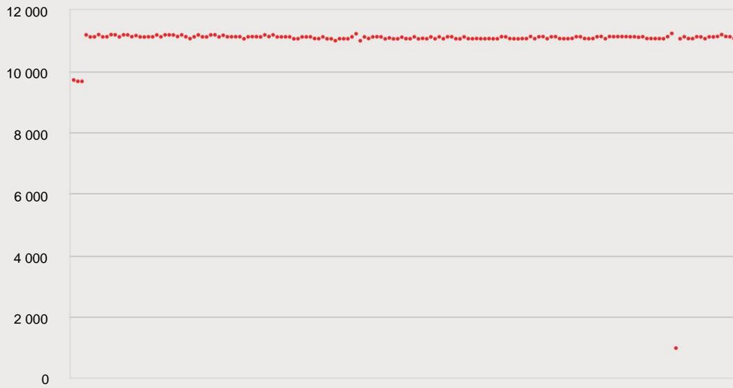
Figure 14 : Énergie déchargée par cycle par le pack batterie SolaX
