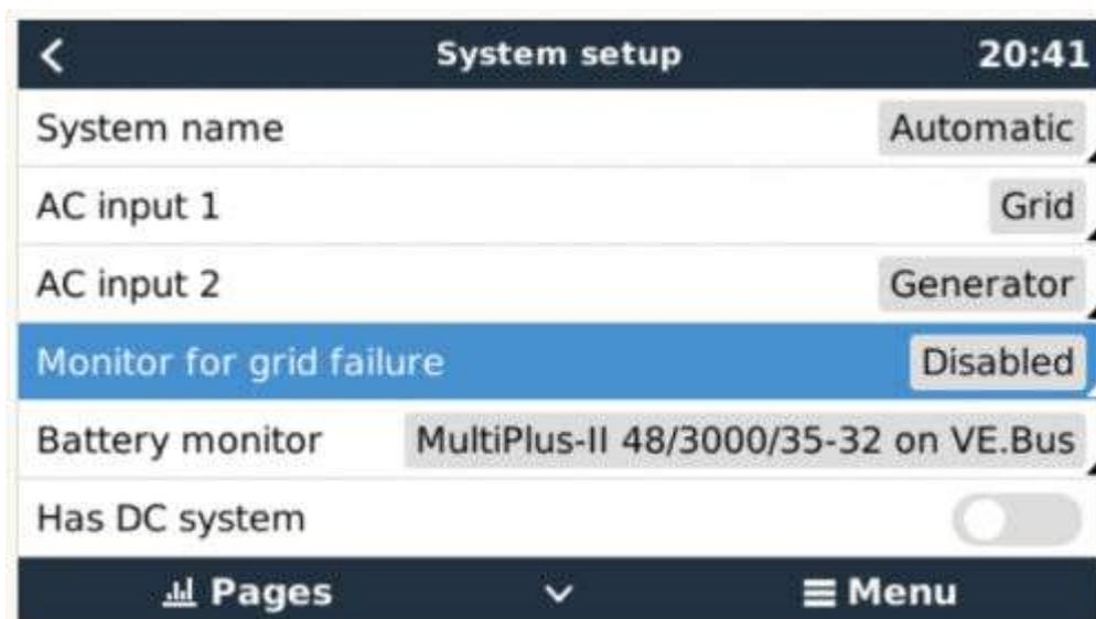
L'alarme s'affiche sous forme de notification dans l'interface graphique et sous forme d'alarme sur le portail VRM. Elle est aussi disponible sur Modbus-TCP / MQTT.
