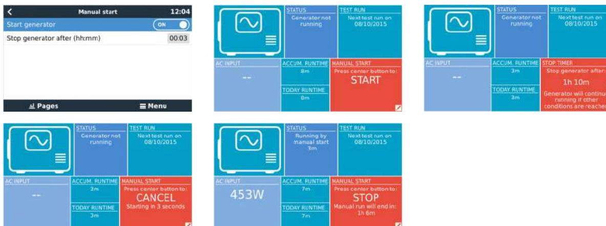
**ATTENTION** : Si le générateur est démarré manuellement (à distance) sans utiliser le minuteur d'arrêt, il fonctionnera jusqu'à ce que le bouton ait été basculé sur Off manuellement.
