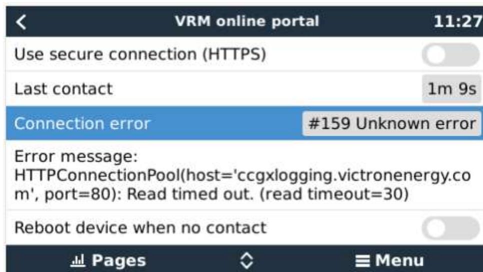
Vérifiez l'indication de « Dernier contact ». Si des tirets sont affichés, cela signifie que le périphérique GX n'a pas été en mesure de contacter le portail VRM depuis la mise sous tension. Si une heure est affichée mais qu'un état d'erreur est toujours visible, cela signifie que le périphérique GX a pu envoyer des données, mais a perdu le contact ensuite.
