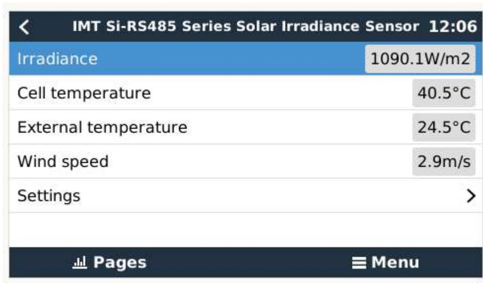
Dans le sous-menu « Paramètres », il est possible d'activer et de désactiver manuellement tous les capteurs externes optionnels/ supplémentaires qui seraient connectés au capteur d'irradiance IMT de la série Si-RS485.
