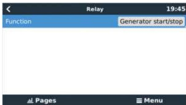
Maintenant qu'il a été activé, tous les paramètres correspondant à la fonction de Démarrage/Arrêt automatique du générateur apparaîtront dans le Menu principal : Paramètres → Démarrage et Arrêt du générateur.
