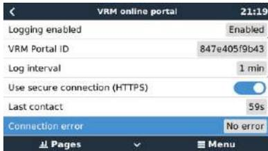
Si une erreur de connexion s'affiche, le Cerbo GX ne peut pas contacter la base de données VRM. L'erreur de connexion affichera un code d'erreur indiquant la nature du problème de connectivité. De plus, les détails du message d'erreur s'affichent pour faciliter le diagnostic du problème par un technicien en informatique.
