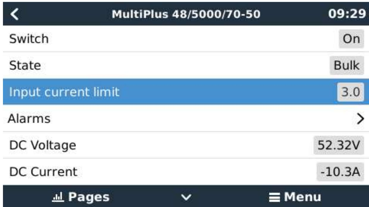
La limite telle que définie par l'utilisateur dans le Cerbo GX sera appliquée à toutes les entrées où « renverser par la commande à distance » est activé, configuré avec VictronConnect ou VEConfigure :
