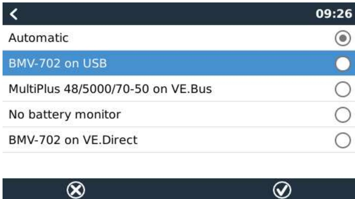
Sur l'illustration ci-dessus, nous avons choisi le réglage automatique. Si vous sélectionnez le réglage automatique, l'écran de configuration du système sera identique à l'illustration ci-dessous.
