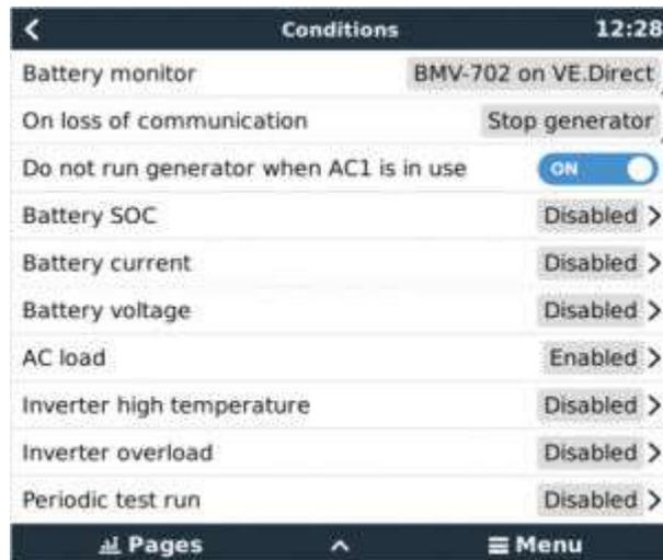
\* **Contrôleur de batterie** : Sélectionnez comment la batterie sera surveillée – si elle doit l'être. Les données du contrôleur de batterie seront utilisées pour des conditions liées au CC.
