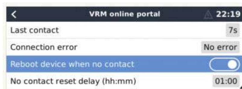
Cette fonctionnalité, désactivée par défaut, commande au périphérique GX de redémarrer automatiquement s'il n'a pu se connecter au portail VRM.
