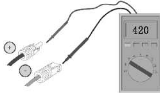
Figure 2-16 PV Contrôle de la polarité
