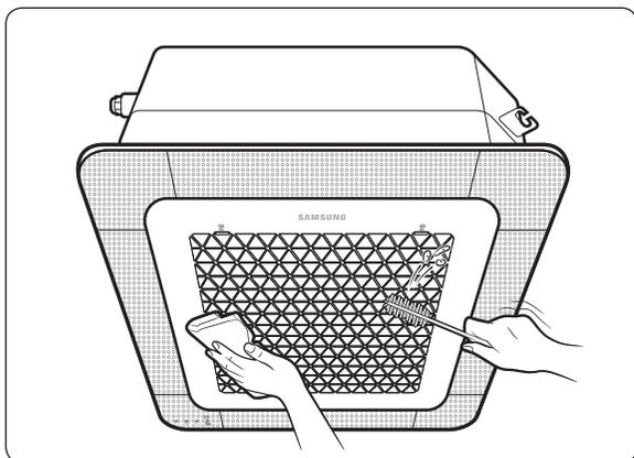
Essuyez la surface de l'appareil avec un chiffon légèrement humide ou sec en cas de besoin. Dépoussiérez les zones aux formes irrégulières en utilisant une brosse douce.
