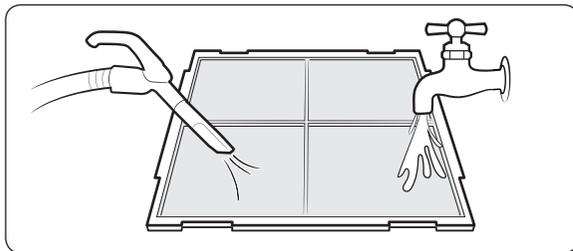
Nettoyez le filtre à air avec un aspirateur ou une brosse douce. Si le filtre est trop chargé en poussière, rincez le filtre sous l'eau courante et laissez-le sécher dans un espace bien ventilé.
