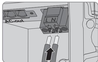
13. Veillez à ce que les conducteurs soient enfichés jusqu'en butée dans les points de serrage (ouvertures rondes) et non pas dans les orifices d'ouverture (orifices carrés).
