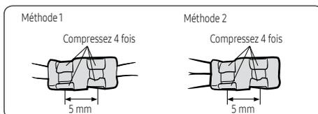
5 Enveloppez-le avec la bande d'isolation deux fois ou plus et placez le tube de contraction au centre du ruban d'isolation.
