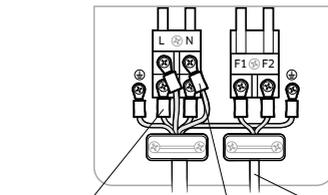
Câble d'alimentation de l'extérieur vers l'intérieur (trois fils)    Câble d'alimentation (trois fils)    Câble de communication cable (deux fils)
