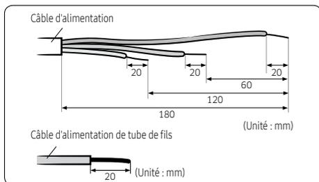
3 Insérez les deux côtés du fil de base du câble d'alimentation dans la gaine de connexion.
