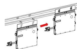
\*Remarque : Installez le micro-onduleur à au moins 50 cm au-dessus du sol/toit pour une meilleure communication avec le DTU Hoymiles.
