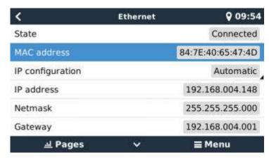
Si vous utilisez Ethernet et que l'état indique « Débranché », vérifiez que le câble de réseau Ethernet n'est pas défectueux en essayant de brancher un autre câble. Les deux voyants à l'arrière du Cerbo GX, au niveau du branchement du câble Ethernet RJ45, doivent être allumés ou clignoter. Deux voyants éteints indiquent un problème de connexion.
