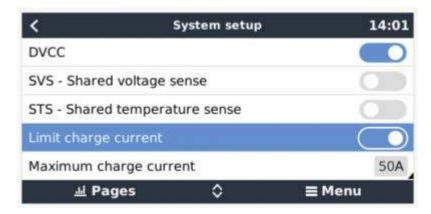
Vous trouverez ce paramètre dans le menu « Paramètres → Configuration système » du périphérique GX.
