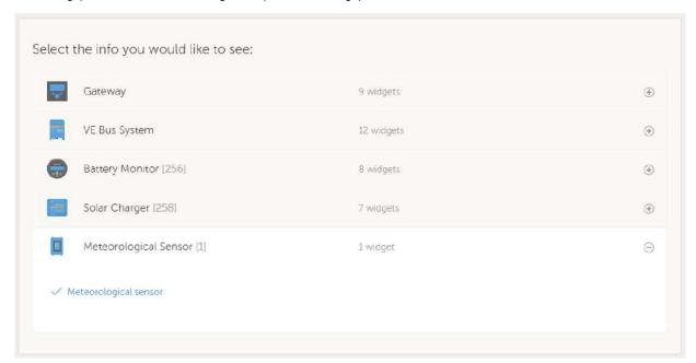
Les données de tous les types de capteurs disponibles s'afficheront automatiquement dans le graphique. Vous pouvez aussi activer ou désactiver les différents capteurs et paramètres individuellement en cliquant sur le nom ou la légende du capteur.
