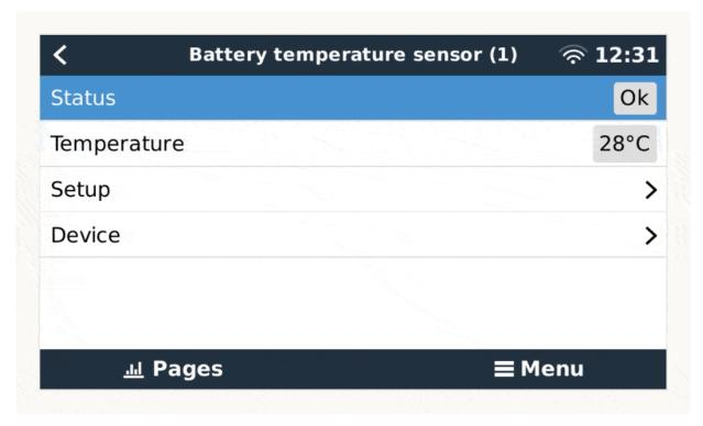
Vous pouvez régler le décalage et l'échelle de température, cependant, pour l'instant, cette fonction est limitée aux utilisateurs disposant d'un niveau d'autorisation de « Super-utilisateur ».
