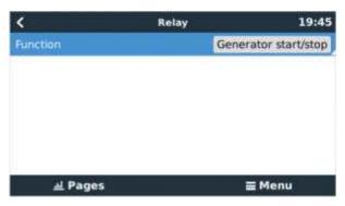
Maintenant qu'il a été activé, tous les paramètres correspondant à la fonction de Démarrage/Arrêt automatique du générateur apparaitront dans le Menu principal : Paramètres → Démarrage et Arrêt du générateur.
