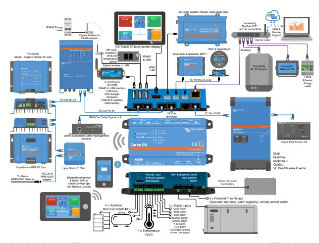
Sur le Cerbo GX, la prise USB la plus proche du connecteur HDMI ne peut être utilisée que pour alimenter un GX Touch. Ce port USB ne peut **pas** être utilisé pour des fonctions liées aux données telles que les câbles de connexion VE.Direct à USB, les clés USB, les GPS-USB ou d'autres utilisations courantes des fonctionnalités USB. Il s'agit d'un port d'alimentation et non d'un port de données.
