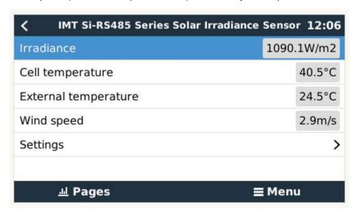
Dans le sous-menu « Paramètres », il est possible d'activer et de désactiver manuellement tous les capteurs externes optionnels/ supplémentaires qui seraient connectés au capteur d'irradiance IMT de la série Si-RS485.
