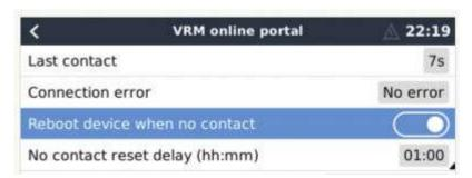
Cette fonctionnalité, désactivée par défaut, commande au périphérique GX de redémarrer automatiquement s'il n'a pu se connecter au portail VRM.
