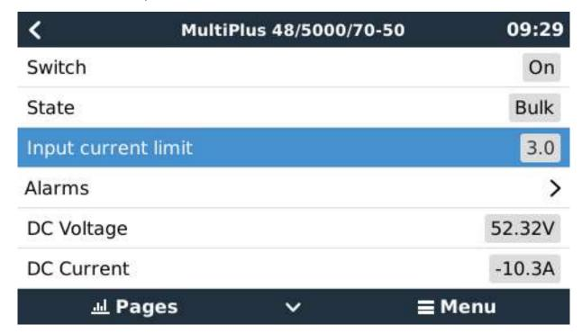
La limite telle que définie par l'utilisateur dans le Cerbo GX sera appliquée à toutes les entrées où « renverser par la commande à distance » est activé, configuré avec VictronConnect ou VEConfigure :
