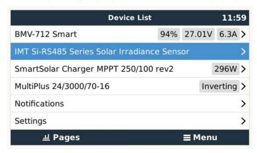
Dans le menu « Capteur d'irradiance solaire IMT de la série Si-RS485 », tous les paramètres disponibles s'afficheront automatiquement (en fonction des capteurs connectés) et seront mis à jour en temps réel.
