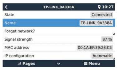
Si vous utilisez le Wi-Fi et que le menu affiche « Aucun adaptateur Wi-Fi connecté », vérifiez la connexion USB au dongle Wi-Fi. Essayez de retirer le dongle et de le réinsérer.
