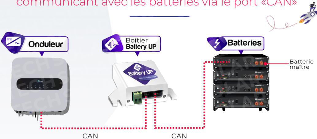
Insérez le câble «**CAN**» dans l'entrée «**CAN**» de l'onduleur et celle de votre boîtier Battery UP.
