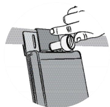
**3** Faites glisser l'ensemble sous la pince, puis déplacez-la légèrement vers la gauche. La vis maintient le cadre de support et la pince. La bride de fixation du micro-onduleur doit être à l'extérieur du cadre du module.
