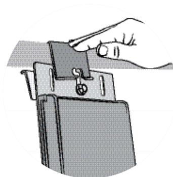
**2** Vissez la vis dans l'insert du support, puis glissez l'encoche du micro-onduleur au travers de la vis.
