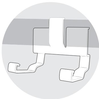
**1** Positionnez le support de connecteur en fonction de la position du micro-onduleur.
