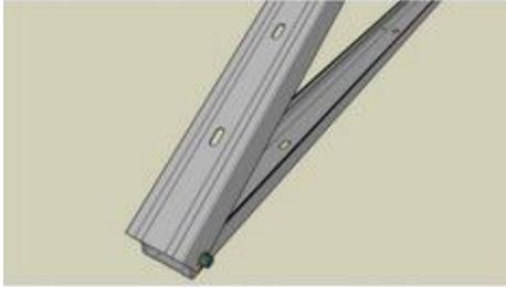
fixez des rails de montage par les trous oblongs (largeur 11mm)
