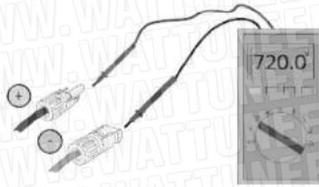
Figure 2-15 Vérification de la polarité PV
