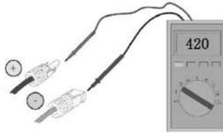
Figure 2-16 Vérification de la polarité PV
