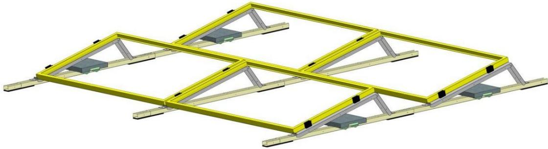
Placez les panneaux sur les triangles de montage et fixez-les avec les pinces d'extrémité et du milieu appropriées.
